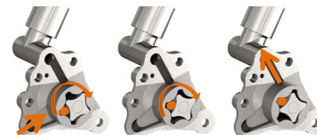
內部為行星齒輪泵設計，運作原理如圖
