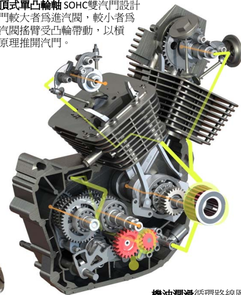
機油潤滑循環路線圖 黃色為機油通道，橘色為欲潤滑之軸
